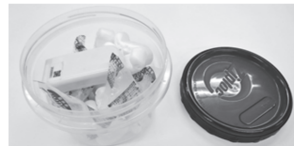
線量計を容器に入れて家屋内に設置
