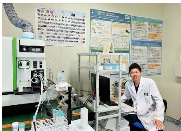
2019年4月から2022年3月まで、三春町にあるCLADSの部署に勤務しておりました。環境中に放出された放射性核種の分析法開発に携わり、写真の誘導結合プラズマ質量分析装置(ICP-MS)を用いて、従来の分析法では測定が難しい長半減期の放射性核種の分析法を開発していました。放射性核種の測定対象とするサンプルには海藻が含まれており、富岡港で毎年海藻を採取し、海産物の安全を確認しています。
