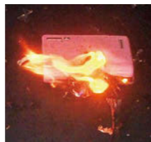
【再現実験】充電中のリチウムイオンバッテリーが発火したもの。
