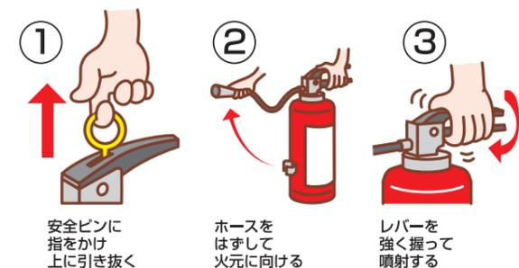
放射の際は、火の根元をねらって、手前からほうきで掃くように消火剤を放射して下さい。消火剤を効果的に放射するため、また、自分の身を守るために消火器は風上から放射します。室内においては、逃げ道を確保し、出入り口を背に放射します。放射時間や放射距離は、本体に必ず表示してありますので確認してください。
