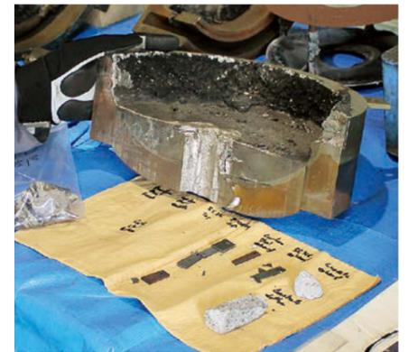
大型試験の試験体(試験後)
