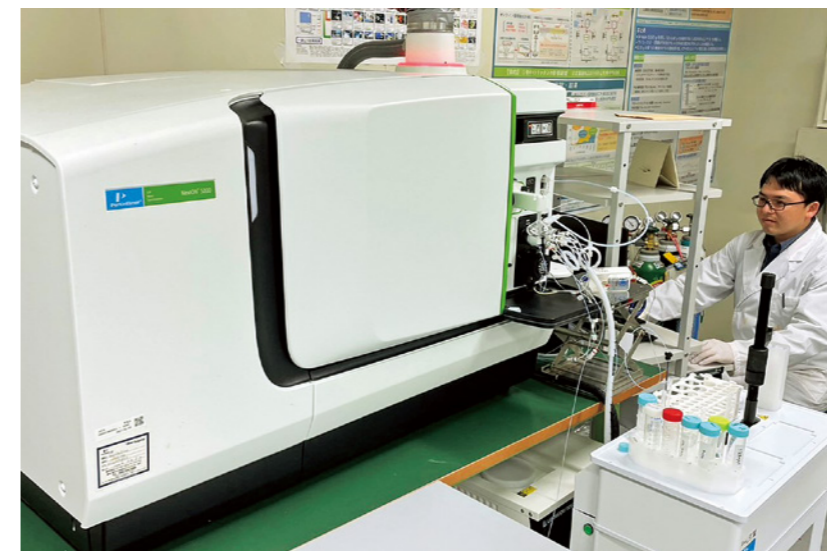
放射性物質の分析を迅速化するために開発した自動分析システム (分析しているのが私です)
