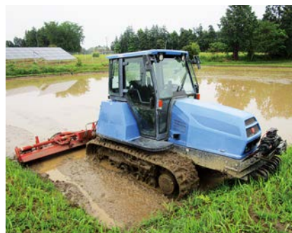
不陸を解消する均平化作業
