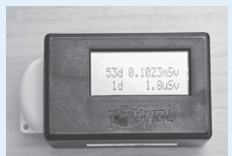
D-シャトルを表示器に差込むことで線量を確認できます ※上段に総積算線量、下段に1日(前日分)の線量を表示。
