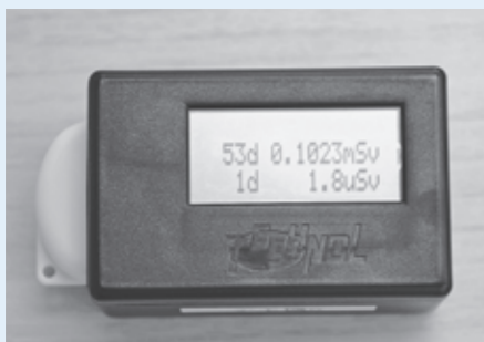
D-シャトルを表示器に差込むことで線量を確認できます ※上段に総積算線量、下段に1日(前日分)の線量を表示。
