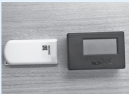
積算線量計 D-シャトル(左)と表示器 ※D-シャトルは希望者全員に、表示器は1世帯あたり1個の貸出しとなります。
